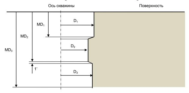
Информация о конструкции скважины, задаваемая в таблице, автоматически отображается на схеме, расположенной справа.
